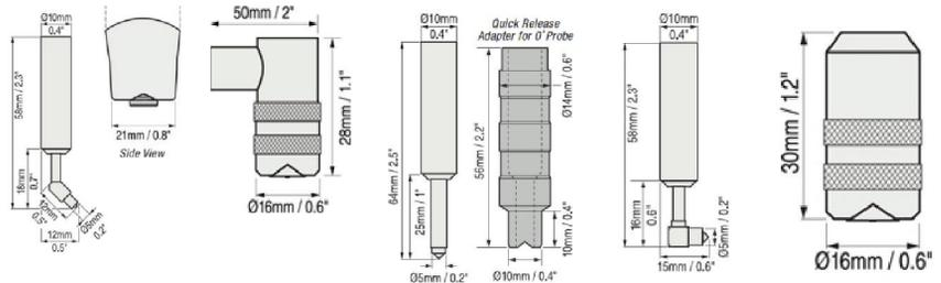
**Medidor de espessura digital para pó ou superfícies pintadas líquidas. Utilizável em materiais ferrosos ou não ferrosos (por exemplo, alumínio). Versão com sonda externa para medições em pontos particularmente difíceis. Versões diferentes para todas as necessidades.**
